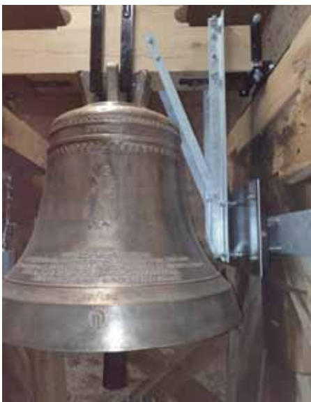
Die neue Glocke mit ihrem verschleißlosen Antrieb durch magnetische Platten
